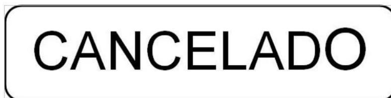
5 - Para os modelos de carimbo (MODELO 2, MODELO 3 e MODELO 4) texto centralizado em letras maiúsculas, fonte Arial, tamanho 22, retângulo medindo 34mmX11mm, cantos arredondados em 1,5mm, moldura com traço de 0,8mm.
